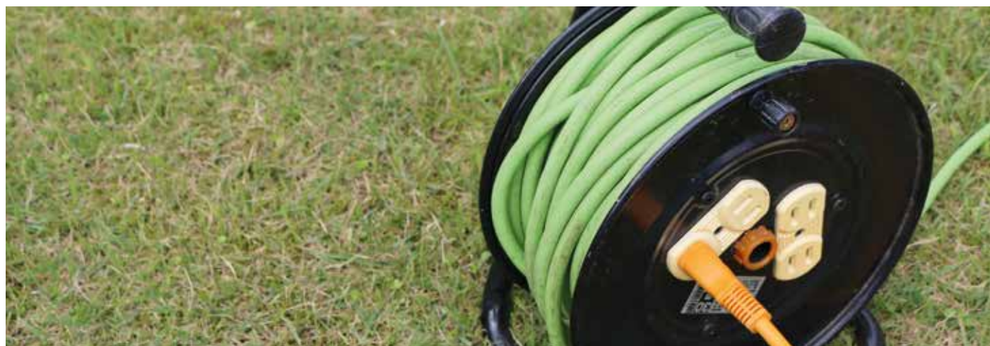
AVVOLGICAVO in materiale termoplastico, cavalletto metallico. Sezione filo 2x1,5 mm 2 Lunghezza 20 m Spina schuko al tamburo, presa schuko al terminale Cod. 41260
